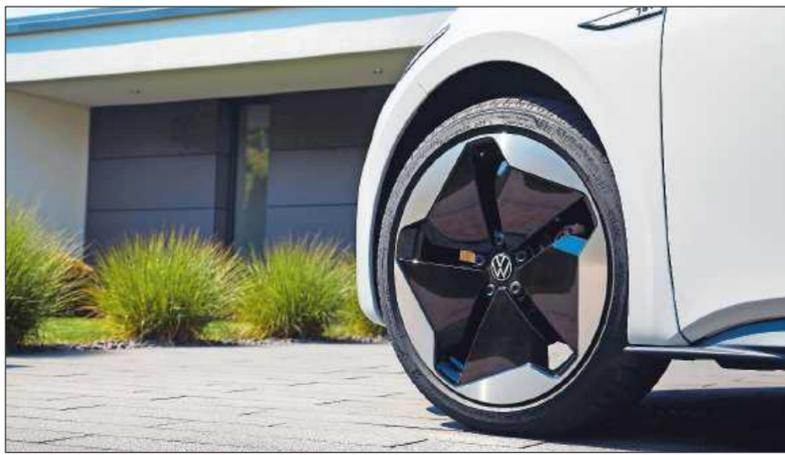
**Passendes Schuhwerk für die Langstrecke: Um die Reichweite eines E-Autos im Blick zu halten, zeichnen sich geeignete Reifen durch einen möglichst geringen Rollwiderstand aus.** FOTO: VW AG/DPA
